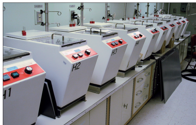
Obr. 1. Baterie promývacích automatů na deglycerolizaci Haemonetics ACP-115 – první plně automatické zařízení tohoto typu.
