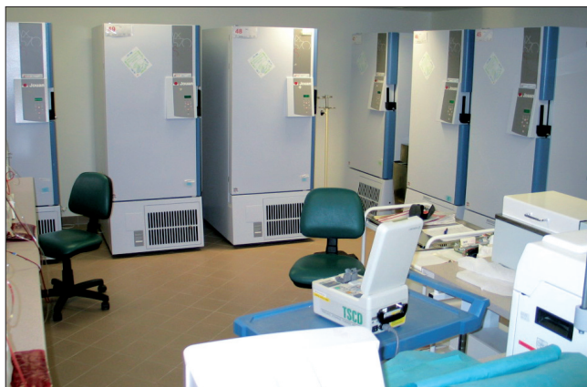
Obr. 3. Mechanické hlubokomrazicí boxy (na min -80^{\circ}\text{C} ).
