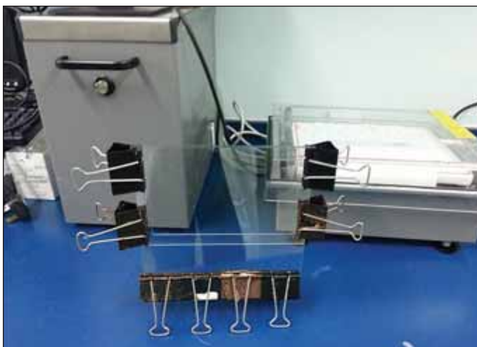
Obr. 2. Elektroforetická zostava pre manuálnu metódu (vlastné údaje).
